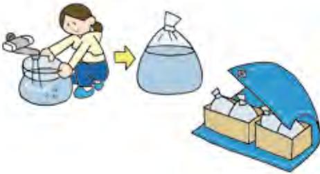
小規模な水災で水深の浅い初期の段階に使う水防工法です。40L程度の容量のごみ袋を二重にして中に半分程度の水を入れて閉めます。ごみ袋の強度に不安があれば重ねる枚数を増やします（買い物用のポリ袋でも代用できます）。作成した水のうを段ボール箱に詰め、レジャーシートなどで包みます。出入口などに隙間のできないように並べます。
