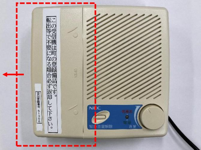
受信機正面の点線の箇所を、フタを左に滑らすように開ける。
