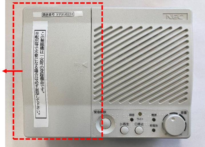
受信機正面の点線の箇所を、フタを左に滑らすように開ける。
